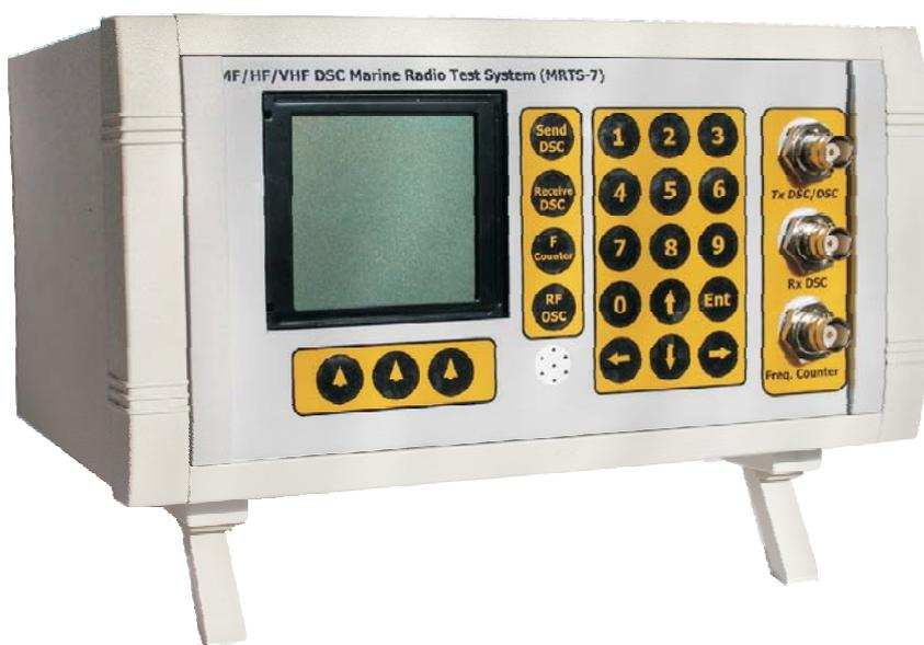
Формирует и проверяет достоверность приема сообщений ЦИВ с передатчика форматов DISTRESS или селективного вызова ТРАФИК.
